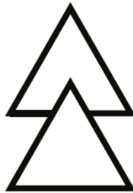
Figura 5.1: Simbolo del doppio triangolo per indicare l'idoneità del DPI come misura contro lo shock elettrico
